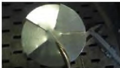
Прорезать по линиям от наружной окружности до внутренней на 3 заготовках;
